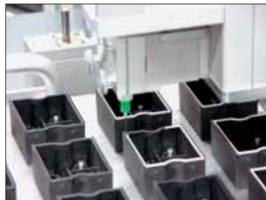
Bild 2. Das Dosiersystem bringt auch in den Ecken exakt die vorher per Software eingestellte Klebermenge auf
